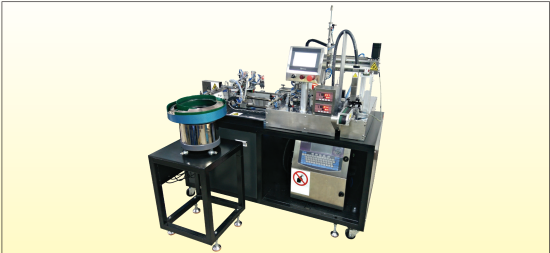
Автоматизированное тестирование прочности припоя на производстве при температуре окружающей среды
